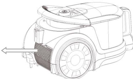
6- Si hay alguna basura en la zona del filtro de entrada de aire, asegúrese de sacar la basura antes de instalar el filtro de entrada de aire.
