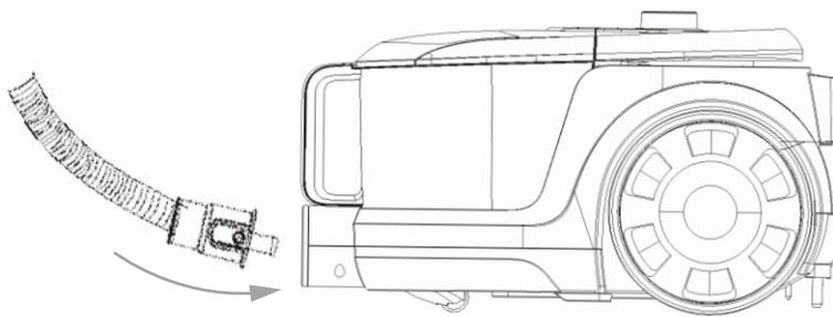
2- Colocar el tubo telescópico a la extensión de manguera curva como muestra el dibujo.
