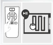
El modo de limpieza más utilizado. Presiona “▶||” en el cuerpo principal o en el control remoto. El robot planifica un camino y limpia siguiendo un patrón en zigzag. Durante la limpieza, el robot detecta y limpia áreas que hayan sido omitidas.
