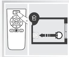
Cuando la batería se agota durante un ciclo de limpieza, el robot activará automáticamente la función de “Carga Automática” -- buscando y regresando a la base de carga para recargarse. Presiona este botón una vez para activar también la función de carga automática. Presiona este botón dos veces para establecer un horario cuando el robot esté en la base de carga. Presiona este botón tres veces para cancelar el horario cuando el robot esté en la base de carga.
