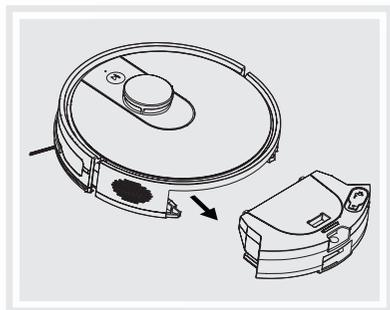
Deslice hacia atrás para retirar los componentes del tanque de agua.
