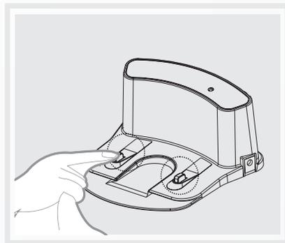
Limpiar regularmente los pines de carga en el robot y en la base de carga con un paño seco.
