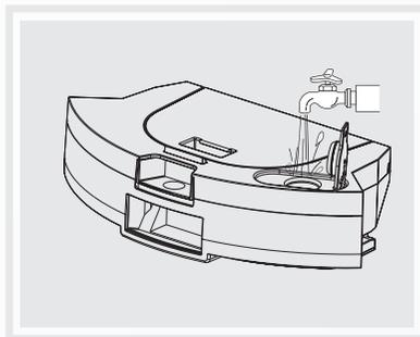
Abra la tapa del tanque de agua, llene el tanque con agua y luego cierre bien la tapa del tanque de agua.
