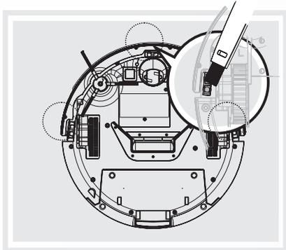
Por favor, apaga primero el robot y limpia los sensores de caída usando el cepillo de limpieza.
