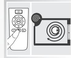
El robot sigue un camino en espiral para limpiar un área específica con concentración de polvo y residuos.
