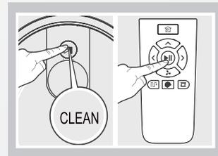
El robot entrará en modo de suspensión, si no hay ningún comando recibido después de que se detenga durante 10 minutos. Presione el botón "INICIO" en el robot o en control remoto para despertarlo.
