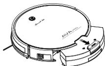
2. Llene el tanque de agua con agua a través del orificio de llenado (**ADVERTENCIA: no introduzca productos de limpieza ya que podrían dañar la aspiradora**) y luego coloque el tanque, junto al trapo, en su AVA PRO.
