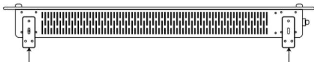
3. Cuelgue el convector en los soportes de gancho que colocó en la pared y deje que los soportes inferiores se apoyen sobre la pared.
